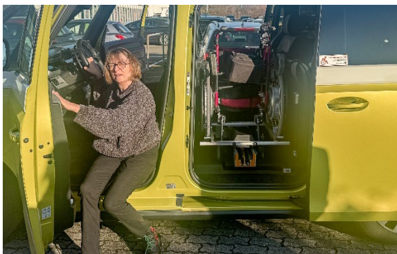
Dank des höhenverstellbaren Rutschbretts mit Liftfunktion gelingt Dorothee der Einstieg in ihren VW ID. Buzz mühelos. Ihr Rollstuhl wird mit der Verladehilfe hinter dem Fahrersitz sicher verstaut – für maximale Unabhängigkeit im Alltag. Foto: Paravan
