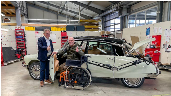
Die kniffligste Aufgabe bei der Fahrzeuganpassung war die Rollstuhlverladehilfe. Doch nun kann der Rollstuhl mit dem Robot 3000 im Kofferraum verstaut werden – per Knopfdruck. Foto: PARAVAN
