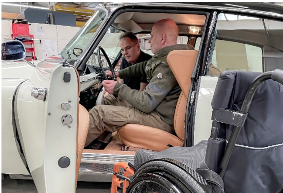
Passt alles, funktioniert alles wie geplant und das ganze ermüdungsfrei? Steffen, testet mit PARAVAN-Techniker Daniel Haberbosch die individuell angepassten Bediengeräte, Foto: PARAVAN
