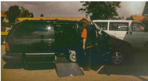
Bereits der erste PARAVAN – ein Chrysler Voyager war mit einer Unterflurrampe und einem Luftfahrwerk ausgestattet. Der Beginn der behindertengerechten Fahrzeuganpassung. Foto: PARAVAN
