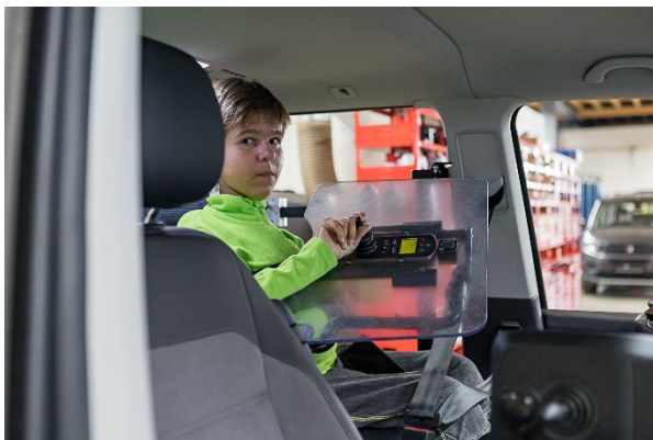
Mit Hilfe einer Eigenkonstruktion, kann er seinen Tisch vom Rollstuhl inklusive R-Net-Steuerung zur Seite fahren. So ist Platz für den 4-Wege-Joystick fürs Auto. Foto: PARAVAN
