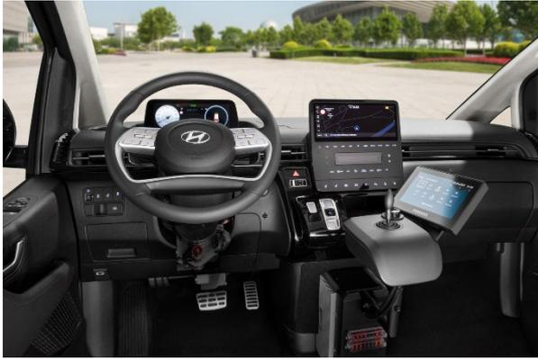
*Alles ist möglich, egal ob eine Ausstattung mit dem Fahr- und Lenksystem Space Drive für die Bedienung von Lenkung, und/oder Gas und Bremse, der Einsatz eines Gasringes oder andere Bediengeräte oder nur eine Beifahrerlösung. Foto: PARAVAN*
