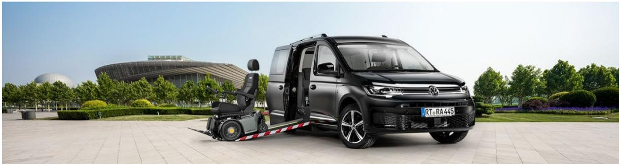
*Per Knopfdruck oder Fernbedienung öffnet sich die Seitentür, das Luftfahrwerk senkt das Fahrzeug ab, die Rampe klappt aus. Viele PARAVAN Kund:Innen schätzen die Lösung mit dem Seiteneinstieg im kompakten VW Caddy 5 Maxi. Foto: PARAVAN*
