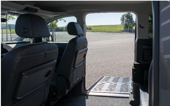
*Die Bodentieferlegung sorgt für eine komfortable Kopffreiheit im Innenraum von über 1,50 Meter, zudem hat der Rollstuhlfahrer die Wahl auf die Fahrer- oder Beifahrerseite zu fahren. Für weitere Passagiere ist im Fonds des Fahrzeuges Platz. Foto: PARAVAN*
