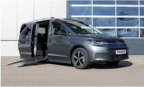
*Per Knopfdruck, Fernbedienung oder per PARAVAN App senkt sich das integrierte Luftfahrwerk, die elektrische Schiebetür öffnet sich und die Rampe kommt herausgefahren, Foto: PARAVAN*
