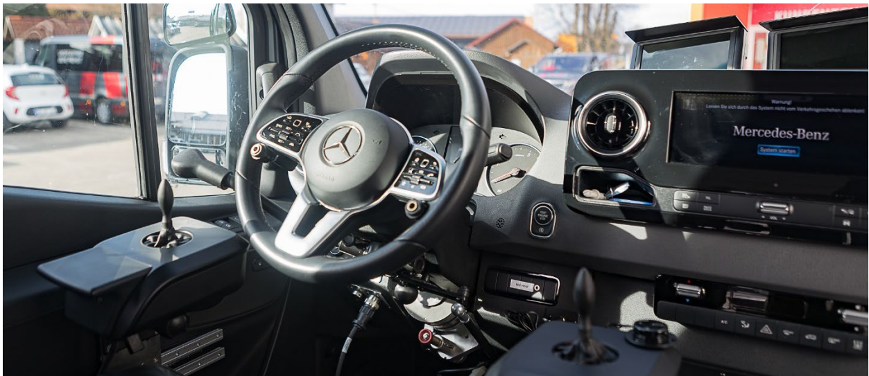
Bis zu 95 Prozent der Beschwerdebilder können mit dem neuen Mercedes-Sprinter ohne größere Anpassungsarbeiten abgedeckt werden. Neu: das innovative Kamerasystem ausgestattet mit Umfelderkennung, welches eine Ausbildung bei Sichtfeldeinschränkung ermöglicht. Foto: PARAVAN
