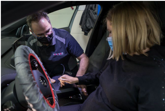
Der Joystick für die Lenkung wird an der Mittelkonsole montiert, im Vorfeld wird schon mal die optimale Position identifiziert. Foto: PARAVAN
